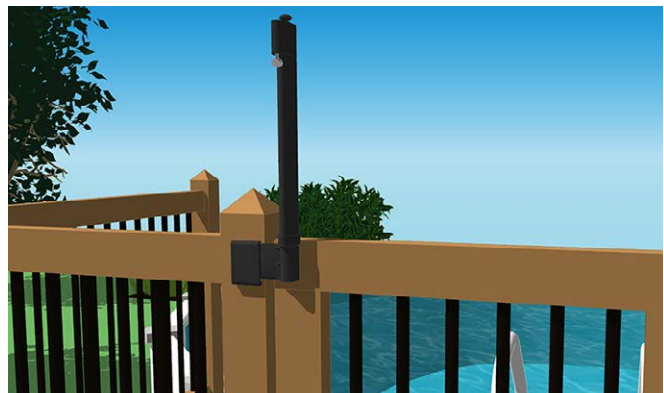
Exemple de loquet pouvant être installé du côté extérieur de l'enceinte, même lorsque celle-ci mesure moins de 1,5 m de haut.
